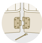
Fissazione del sommier alla testiera con perno
